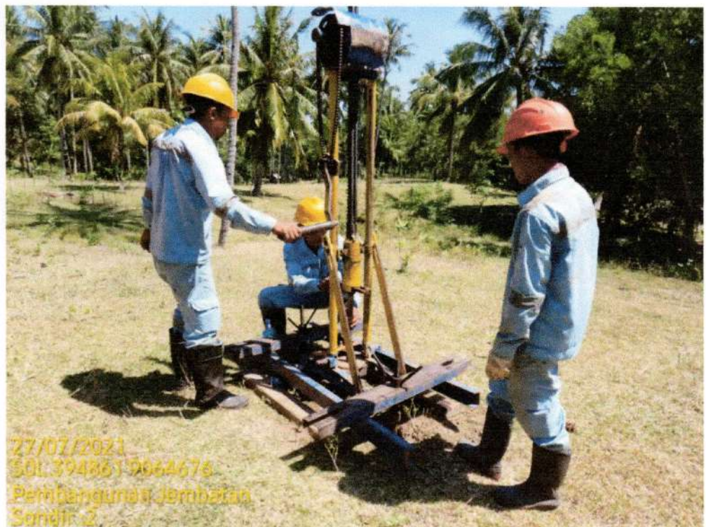
Foto. 2 . Pelaksanaan Pengujian Sondir Titik Jembatan di Malaka, Pemenang, Lombok Utara, Nusa Tenggara Barat
