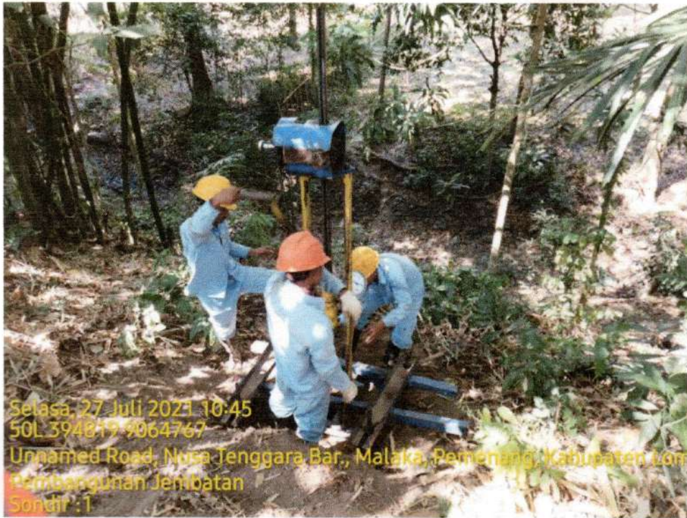
Foto. 2 . Pelaksanaan Pengujian Sondir Titik Jembatan di Malaka, Pemenang, Lombok Utara, Nusa Tenggara Barat
